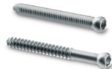
Tornillos autorroscantes: Rosca de doble paso para su rápida introducción en la cortical. Tornillos de cortical de 5,0 mm de diámetro L = 14 – 85 mm Tornillos de esponjosa de 5,0 mm de diámetro L = 50 – 85 mm
